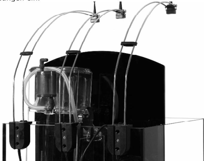
Danach steckt man die einzelnen Leuchten in die zugehörigen Halterungen. Die Leuchte mit dem kürzeren Bügel kommt in die Mitte. Mit Hilfe eines Dreifachkabels verbindet man die Stromleitungen mit dem Transformator.
